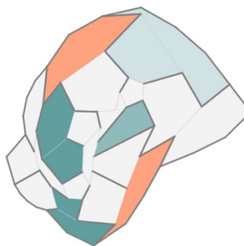
Рис. 2 – Карты Вороного: модель в которой объекты представлены ячейками, а связи между объектами соприкосновением ячеек. Разделение ячеек разделителем соответствует отсутствию связи. Метрики можно задавать в виде размера, цвета и прозрачности.
